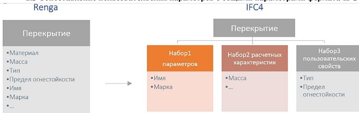
Рисунок 16 – Схема маппинга параметров перекрытия из модели Renga в модель IFC
